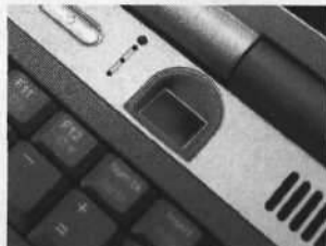
Рис. 1.18. Оптический сканер отпечатка пальца, вмонтированный в ноутбук
